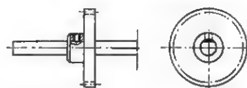
Rys. 4. Umocowanie koła zębatego na osi (wrzecionie)
