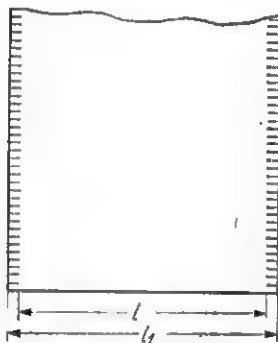
Rys. 1. Fragment paska ceratki z nacięciami l - długość korpusu, l_1 = l + 2 \times (1,5 + 2 \text{ mm})
